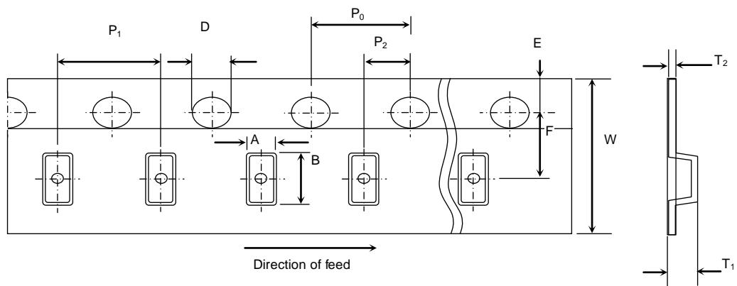
For  $W=8\text{mm}$ :  $T_1=2.5\text{mm}$  max.
